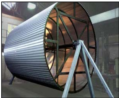
Neue Trommel für Spiralfroster für eine Bäckerei in Irland
