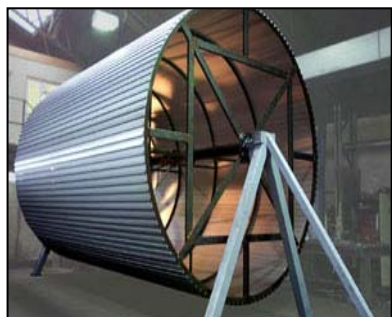
Nuovo tamburo per congelatore a spirale, fornito a una panetteria in Irlanda
